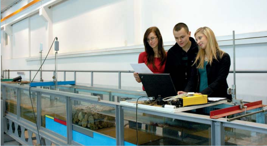
Studenci w trakcie badań modelu progu gabionowego (fot. L. Szymański)
